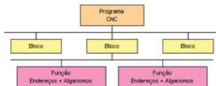
Figura 12 - Estrutura de um programa CNC.
