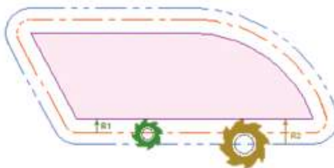
Figura 30 – Compensação do raio da ferramenta.
