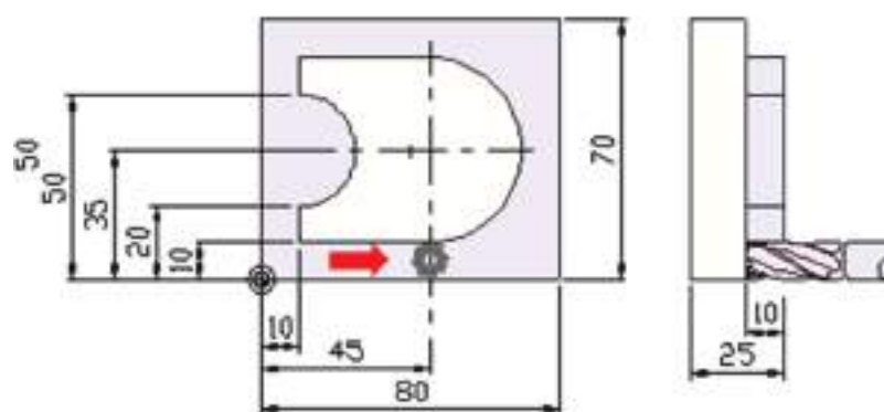
Figura 31 - Ferramenta à direita do contorno G42.
