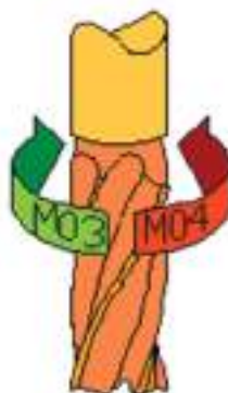
Figura 14 – Rotação da árvore.
